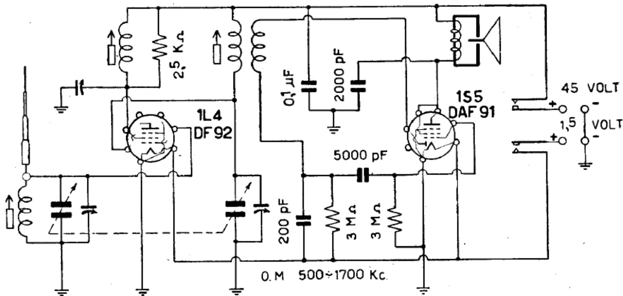
**ZENITRON RADIO - Mod. DERBY RT 21** - Apparecchio ricevente portatile a mano, da usare come si usa l'apparecchio telefonico, provvisto di antenna a telescopio, retrattile, lungo 40 cm. Funziona con due valvole, da 1,4 volt, e pile a secco presenti nell'interno dell'apparecchio. Potenza d'uscita 1,5 milliwatt. Dimensioni 18, 5,5, 6 cm. Peso 500 grammi.
